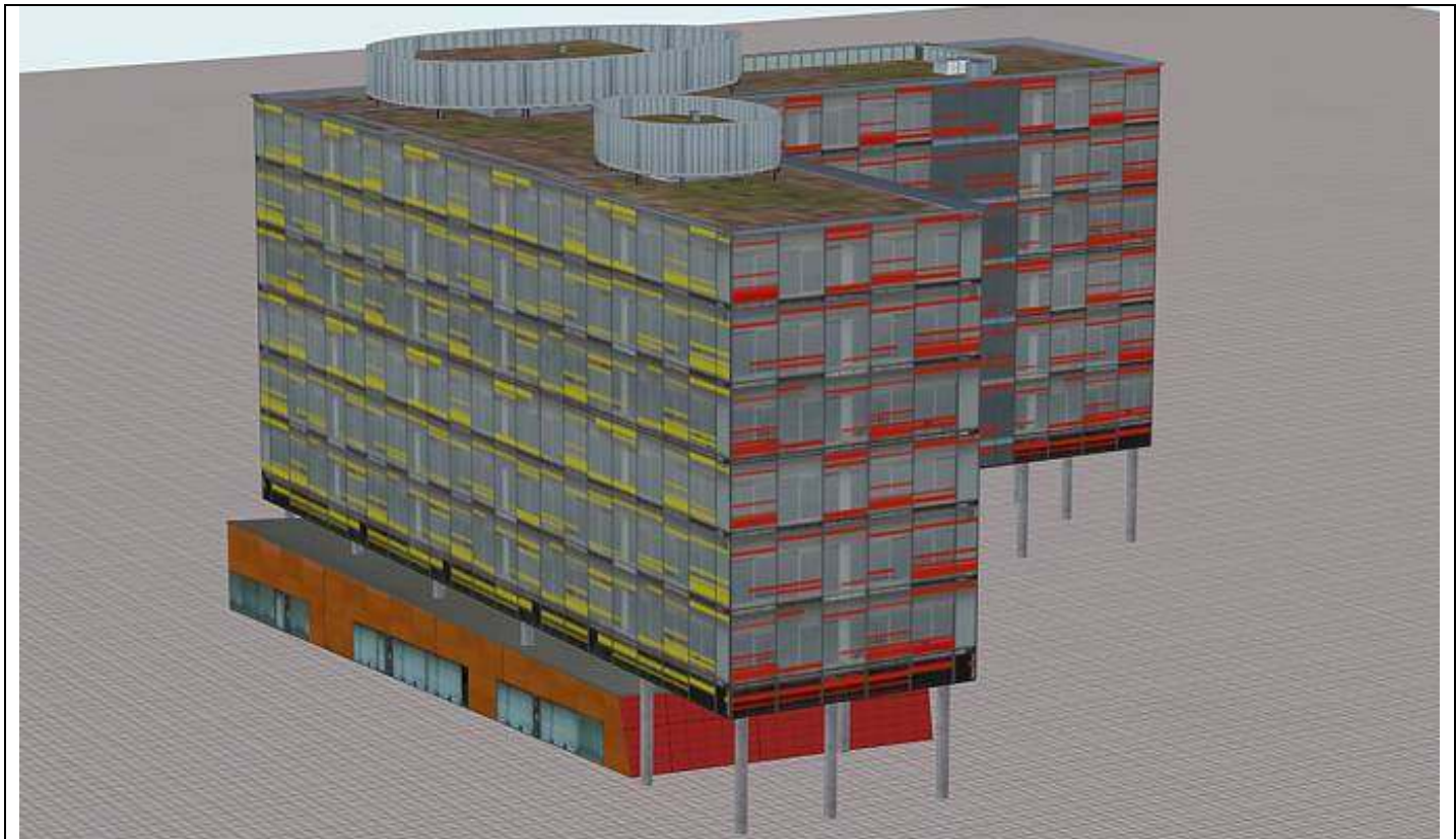
Südwestansicht von BTC_Geb_25_AF1 : L-förmiges, sechsstöckiges Bürohaus mit separatem Untergeschoss BTC_U_25_AF1 und Fahrstuhlschacht BTC_TH_25_AF1 . Kantenlänge links und hinten ca. 55 m; Gebäudebreite ca. 14 m; Grundfläche ca. 1300 m 2 . Auf dem Dach angedeutete Betriebseinrichtungen einschl. Klimaanlage. Ladezeit 0,18 ms.
