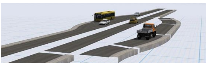
Typischer Aufbau einer Bushaltebucht
