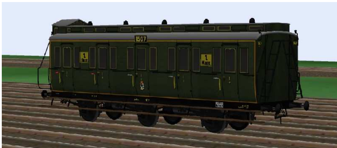
1.Klasse-Wagen mit der Nummer Berlin 1507, mit Bremserhaus und 6,5 m Radstand.
