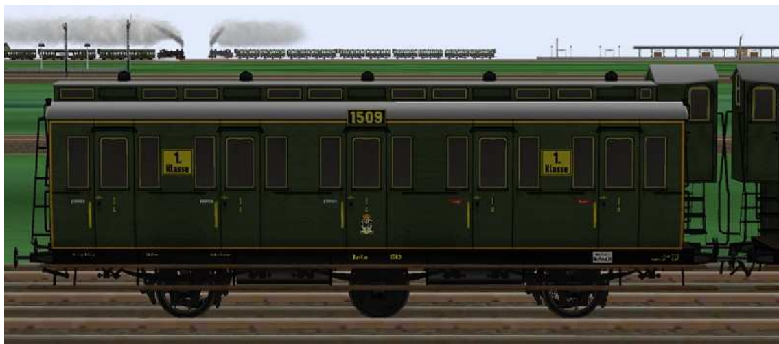
1.Klasse-Wagen mit der Nummer Berlin 1509, mit Bremserhaus und 6,5 m Radstand.
