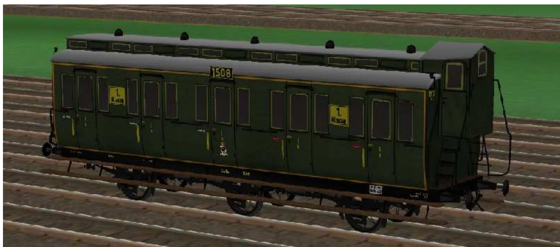
1.Klasse-Wagen mit der Nummer Berlin 1508, mit Bremserhaus und 6,5 m Radstand.
