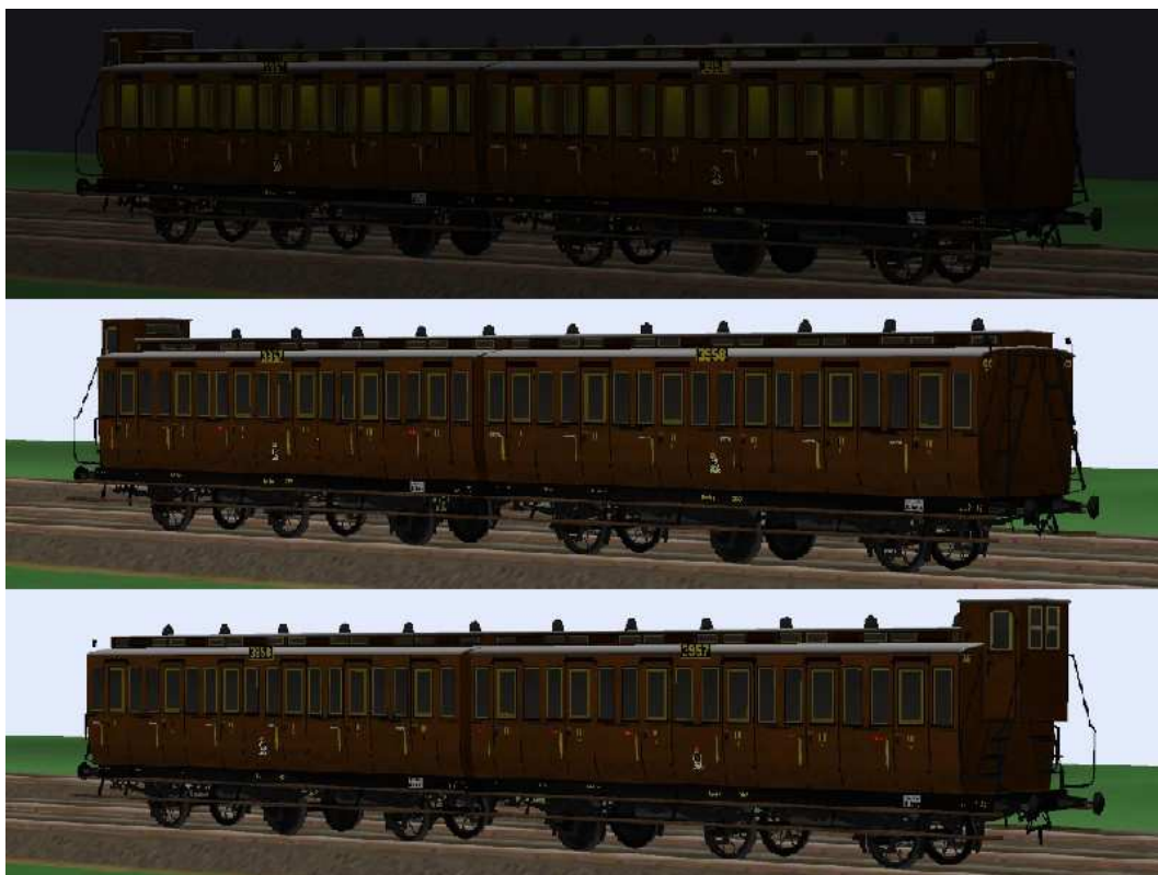
kurzgekuppelte 3.Klasse-Wagen mit den Nummern Berlin 3957/3958, mit Bremserhaus und 6,5 m Radstand.
