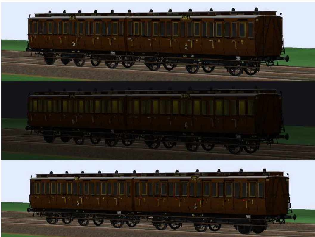
kurzgekuppelte 3.Klasse-Wagen mit den Nummern Berlin 3953/3954, ohne Bremserhaus und 6,5 m Radstand.
