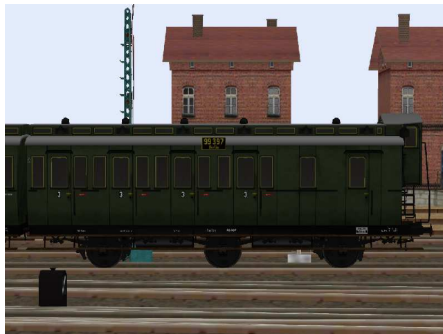
kurzgekuppelte 3.Klasse-Wagen mit kleinem Gepäckabteil Nummern Berlin 99 397/70 977.
