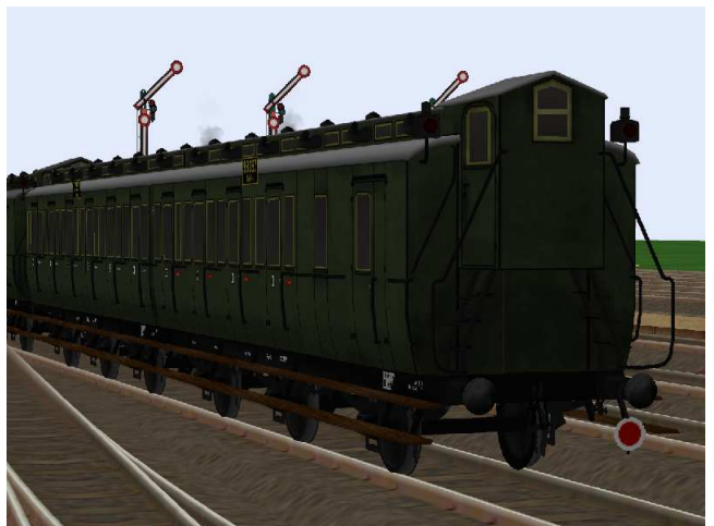
kurzgekuppelte 3.Klasse-Wagen mit kleinem Gepäckabteil Nummern Berlin 99 397/70 977.
