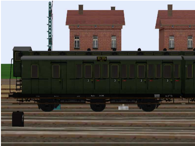
kurzgekuppelte 3.Klasse-Wagen mit kleinem Gepäckabteil Nummern Berlin 99 395/70 972.
