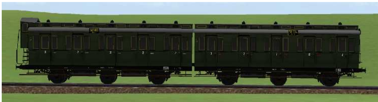
kurzgekuppelte 2.Klasse-Wagen mit den Nummern Berlin 50 503 / 50 504, mit/ohne Bremserhaus und 6,5 m Radstand.
