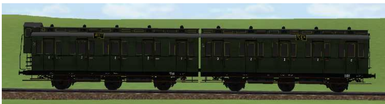
kurzgekuppelte 2.Klasse-Wagen mit den Nummern Berlin 50 633 / 50 634, mit/ohne Bremserhaus und 6,5 m Radstand.
