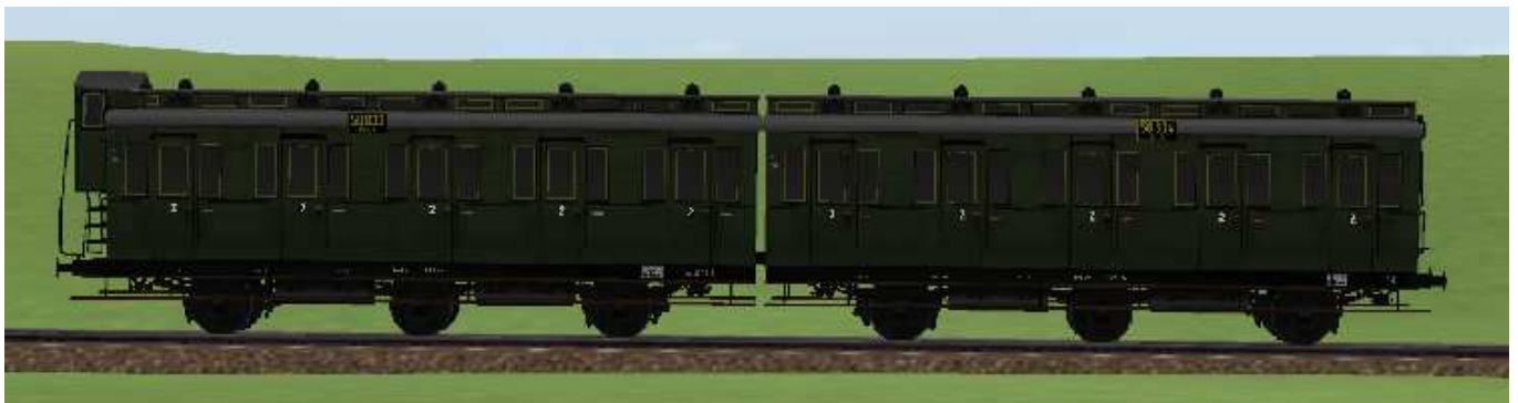
kurzgekuppelte 2.Klasse-Wagen mit den Nummern Berlin 50 833 / 50 834, mit/ohne Bremserhaus und 6,5 m Radstand.
