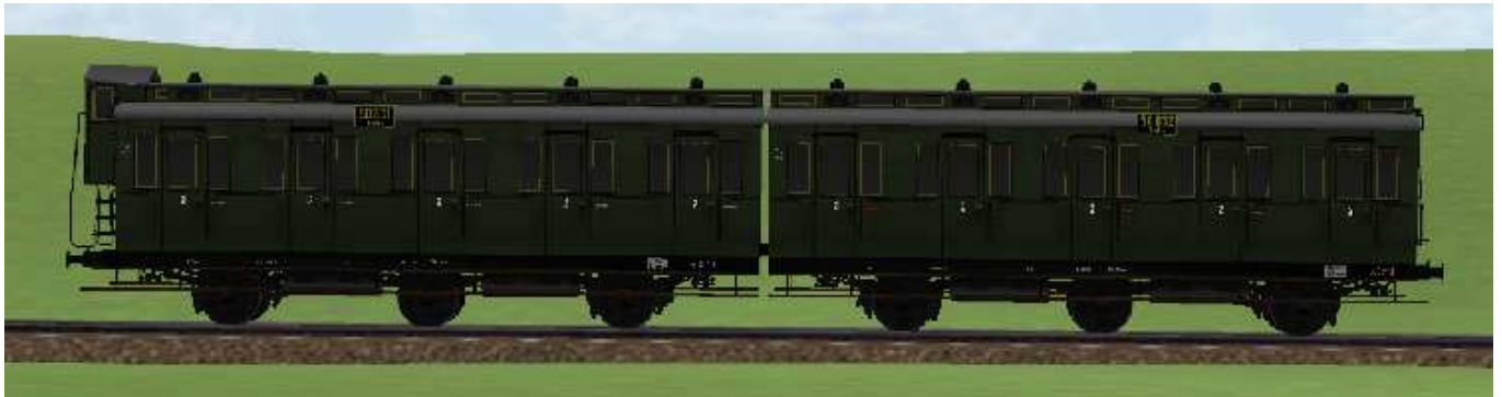
kurzgekuppelte 2.Klasse-Wagen mit den Nummern Berlin 50 831 / 50 832, mit/ohne Bremserhaus und 6,5 m Radstand.
