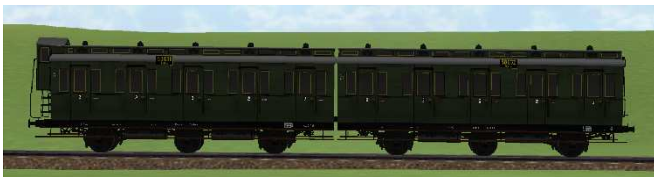
kurzgekuppelte 2.Klasse-Wagen mit den Nummern Berlin 50 631 / 50 632, mit/ohne Bremserhaus und 6,5 m Radstand.
