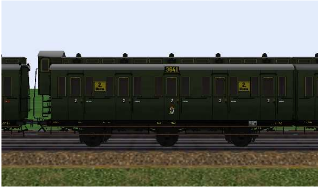
kurzgekuppelte 2.Klasse-Wagen mit den Nummern Berlin 3641/3642, mit/ohne Bremserhaus und 6,5 m Radstand.
