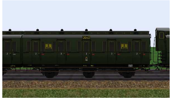
kurzgekuppelte 2.Klasse-Wagen mit den Nummern Berlin 3641/3642, mit/ohne Bremserhaus und 6,5 m Radstand.
