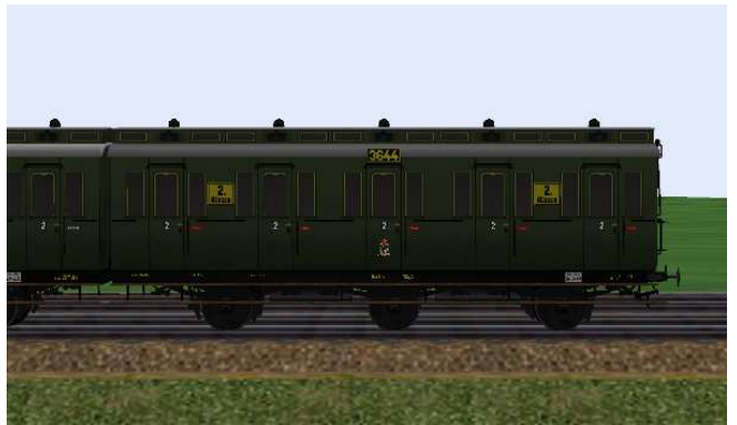
kurzgekuppelte 2.Klasse-Wagen mit den Nummern Berlin 3643/3644, mit/ohne Bremserhaus und 6,5 m Radstand.
