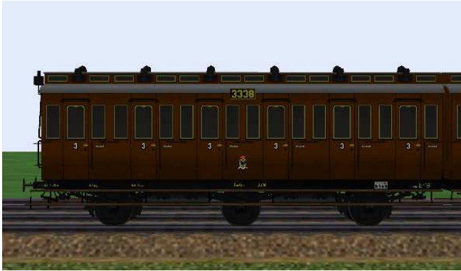
kurzgekuppelte 3.Klasse-Wagen mit den Nummern Berlin 3338/3337, mit/ohne Bremserhaus und 6,5 m Radstand.
