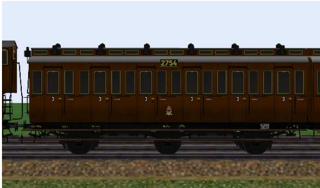
kurzgekuppelte 3.Klasse-Wagen mit den Nummern Berlin 2753/2754, mit/ohne Bremserhaus und 6,5 m Radstand.
