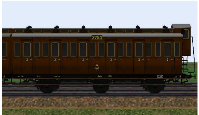
kurzgekuppelte 3.Klasse-Wagen mit den Nummern Berlin 2753/2754, mit/ohne Bremserhaus und 6,5 m Radstand.
