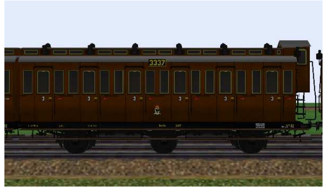
kurzgekuppelte 3.Klasse-Wagen mit den Nummern Berlin 3338/3337, mit/ohne Bremserhaus und 6,5 m Radstand.
